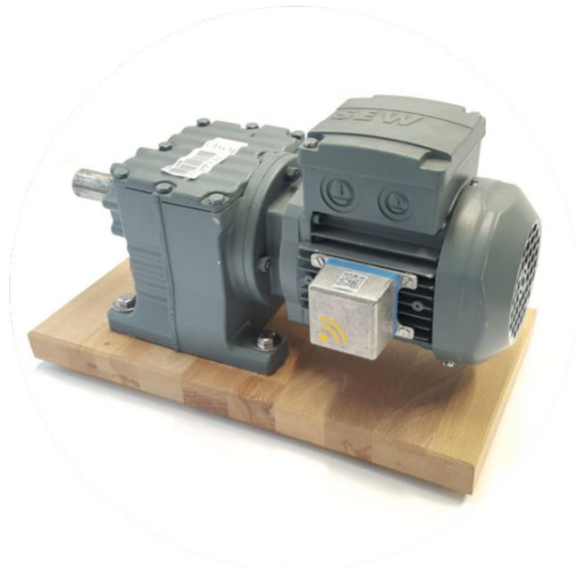
» Eine nachträglich installierte Retrofit-Box ermittelt über integrierte Sensoren und KI-Algorithmen den Zustand eines Antriebs.
