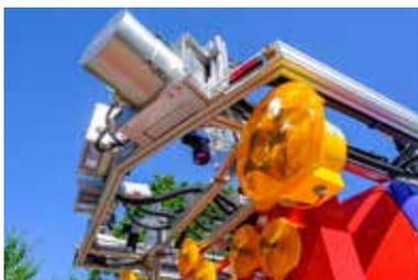
Messfahrzeuge mit Laserscannern, Kameras und Ortungssystemen nehmen die Bauareale auf. Für die KI-basierte Dateninterpretation werden die 2D- und 3D-Messdaten zusammengeführt.
