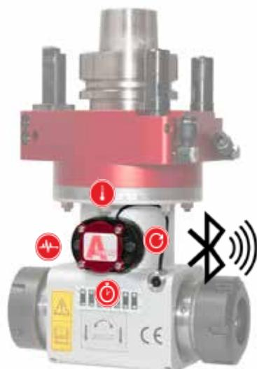
Die Sensoren werden mittels Akkumulatoren prozessnah in die Maschinen integriert und können durch Funkschnittstellen wie zum Beispiel Bluetooth ausgelesen werden.
